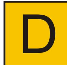
**Orientierungszeichen „PZB“** zur Kennzeichnung des Standortes eines zeitweise wirksamen 2000 Hz- Magneten.
